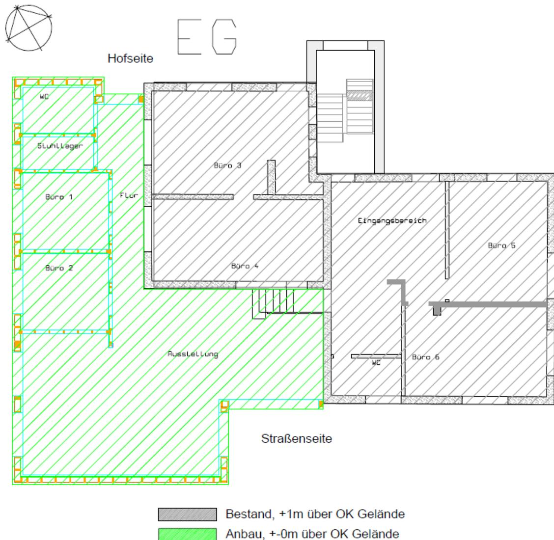
Abbildung 2: Entwurf des neuen Bürogebäudes (EG)
