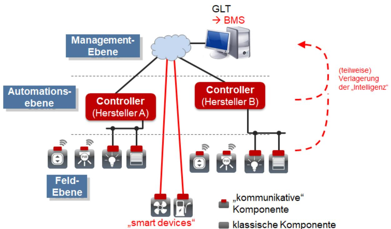
Abbildung 1: Ebenen der Gebäudeautomation inklusive Verlagerung der „Intelligenz“
